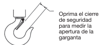
Figura 5 - Inspección del gancho
